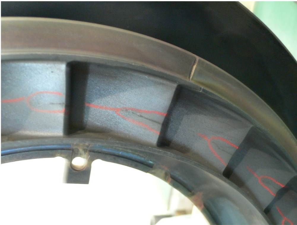
写真 2. 11-18 第 1 段固定翼後縁部のひび割れ
